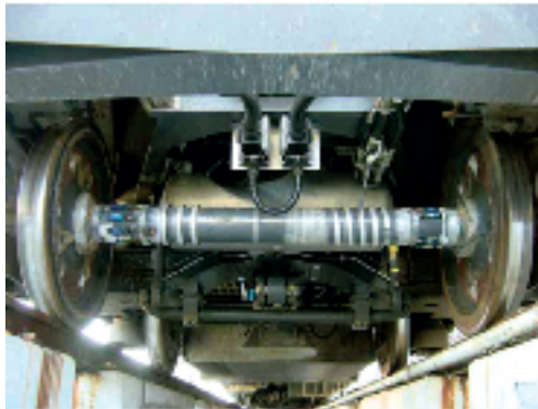
Messung im Bahnbetrieb: Messung von Kräften zwischen Rad und Schiene mit den Mini-Telemetriemodulen (Bombardier Transportation, Portugal).
