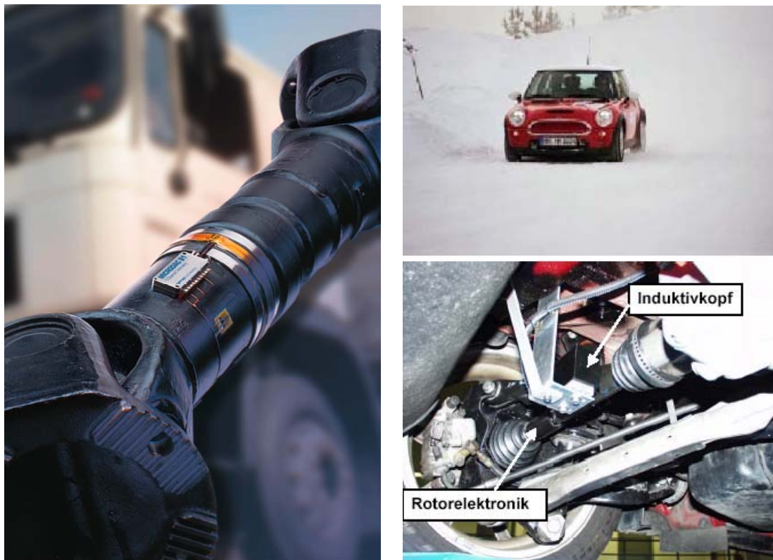
Bild 2: Montage einer 1-Kanal-Telemetrie für Drehmomentmessung auf Kardan- und Seitenantriebswellen
