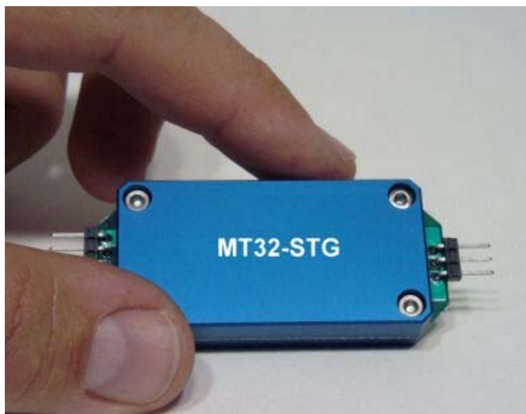
Abbildung 1: Die extrem kleinen MT32-Module beinhalten die komplette Signalaufbereitung, Filterung und Digitalisierung für einen DMS-, ICP- oder Thermo-Kanal
