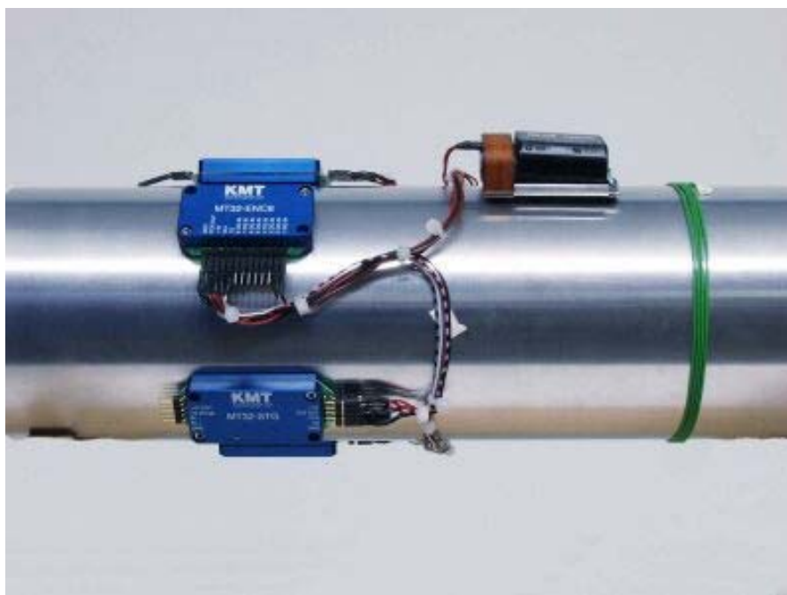
Abbildung 2: Applikationsbeispiel mit DMS-Modulen, Multiplexer- und Sendemodul, Akku-Pack und Ringantenne auf einer rotierenden Welle
