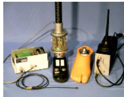
Telemetrische Datenerfassung in der Prothetik: Erfassung von Kräften und Momenten an Prothesen, die sich im täglichen Gebrauch befinden.
