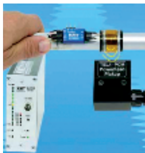
1-Kanal-Telemetrie mit induktiver Spannungsversorgung.
