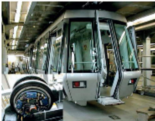
Sky-Train am Flughafen Düsseldorf: 6-Kanal-Telemetrie zur Messung von Radkräften an den Führungsrollen der Schwebbahn.
