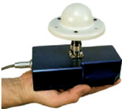
WLAN-Telemetrie: Über eine standardisierte WLAN-Verbindung werden kontinuierlich kleinere Datenpakete gesendet und empfangsseitig auf Korrektheit geprüft.
