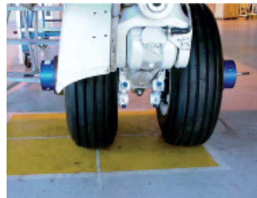
8-Kanal-Rotationstelemetrie zur Messung und telemetrischen Übertragung von Radkräften an einem Flugzeug-Leitwerk. Alle Abb.: KMT
