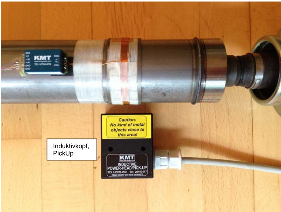
Messwelle mit positioniertem Induktivkopf (Stator), Abstand Spule <-> Induktivkopf 1...2cm
