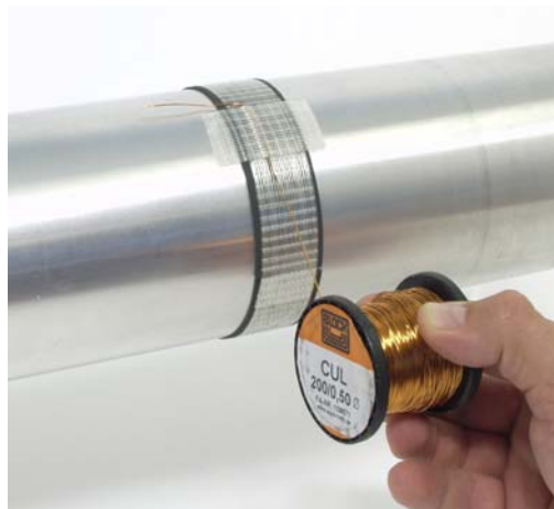
5...15 Wdg. Cul-Draht um das Ferrit-Tape wickeln
