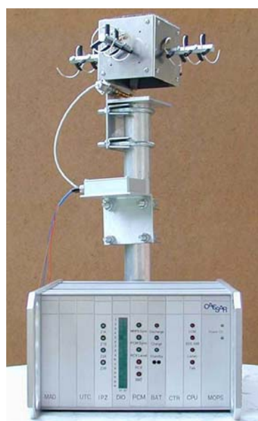
Bild 6: Telemetrie-Empfangsanlage mit vier zirkular polarisierten Rundumstrahlantennen und direkter, digitaler Einspeisung in das PCM-Interface eines Erfassungssystems
