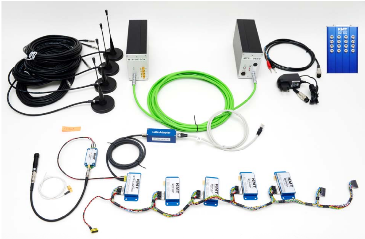
Bild 9: MTP, modular aufgebaute Telemetrie, 8-Kanaäle, Übertragungsrate 2,5Mbit/s mit "Quad-Channel Diversity-Receiver" (4 Empfangsantennen)
