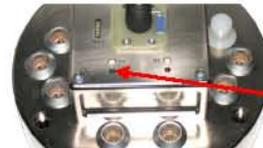
Das Einschalten der Mobileinheit erfolgt durch Betätigung des Tasters "On" und wird durch die grüne LED angezeigt.
