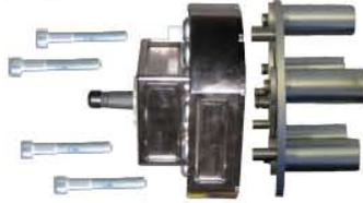
Sensoren mit Lemosteckern konfektionieren und in die Buchsen 1...8 einstecken
