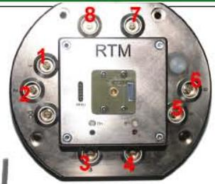
Mitgeliefertenes Versorgungskabel an die Buchse "8...32VDC" der Wiedergabeeinheit stecken und die Bündelstecker mit DC-Quelle verbinden.
