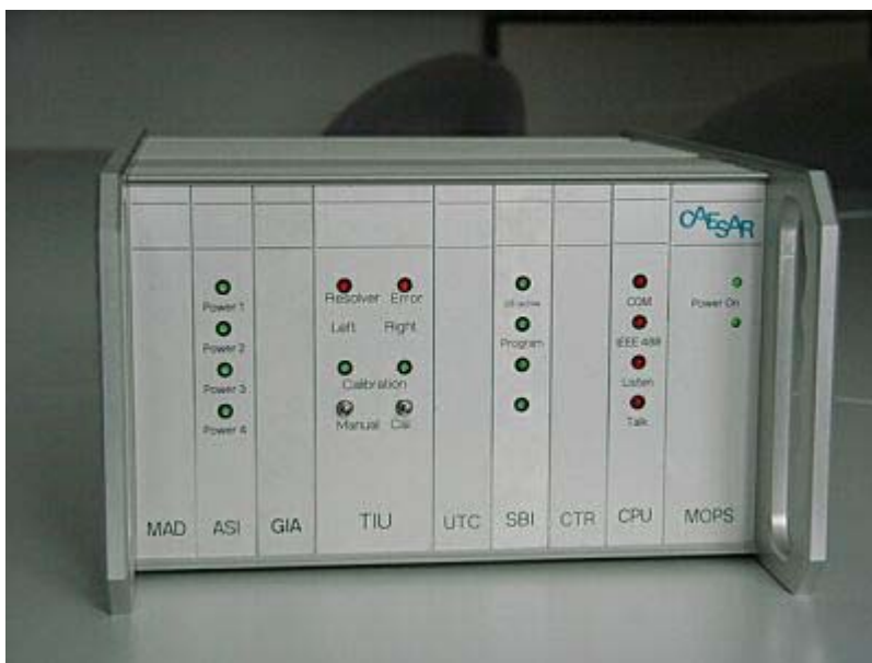
Bild 3: Das Vielkanal-Meßsystem MOPS ermöglicht die parallele Erfassung von Radlasten und beliebigen anderen Versuchsparametern
