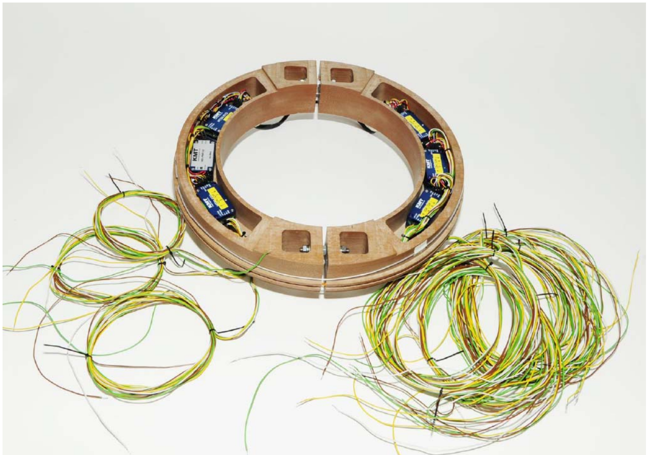
9-Kanal Ringtelemetrie für DMS
