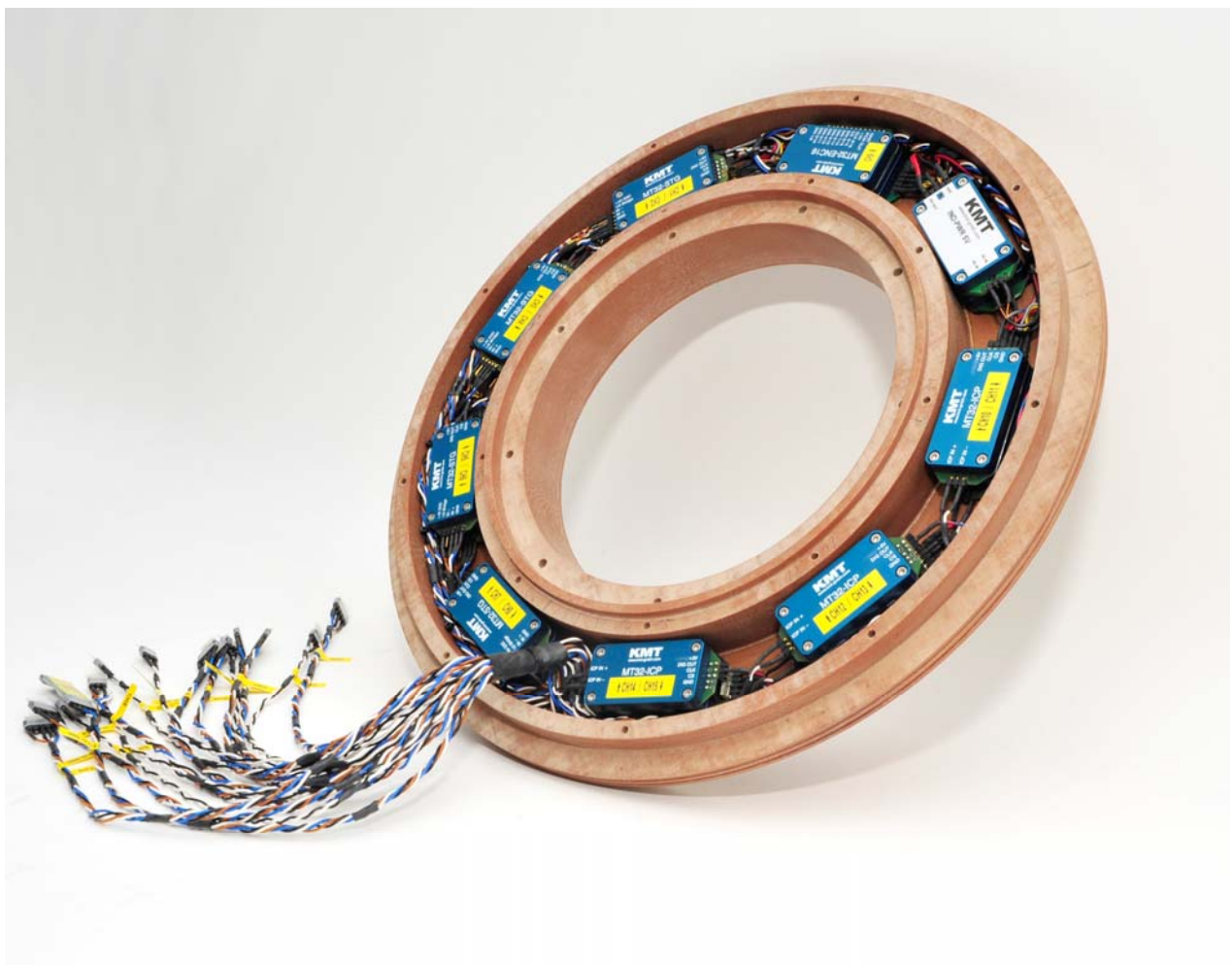
16-Kanal Ringtelemetrie (Encoder) für DMS
