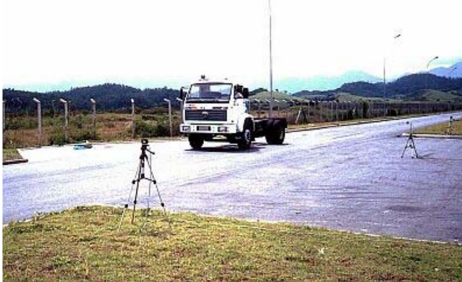
Bild 1: Pass-By-Noise-Versuch mit LKW-Zugmaschine
