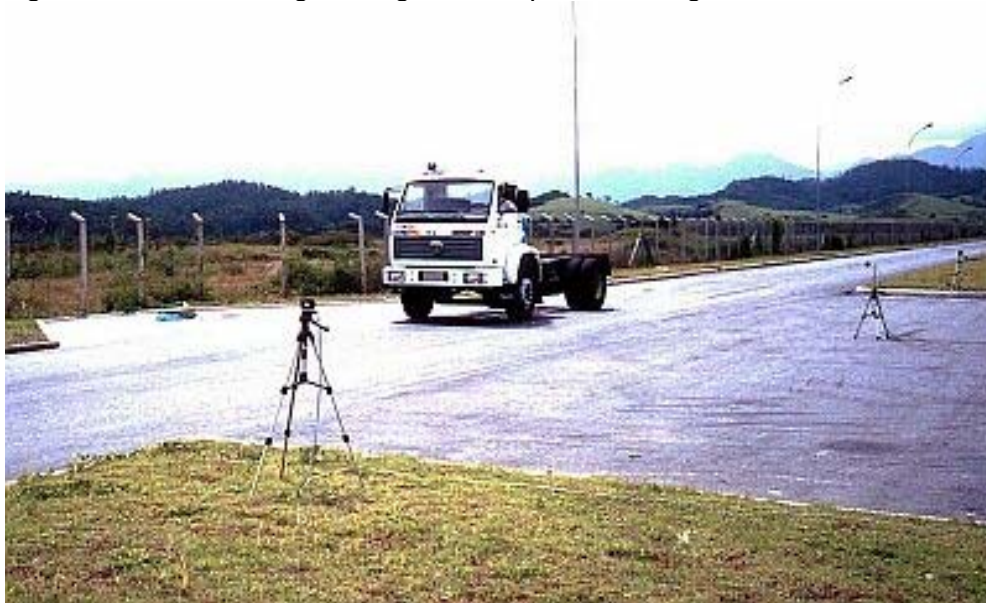
Bild: Pass-By-Noise-Versuch mit LKW-Zugmaschine
