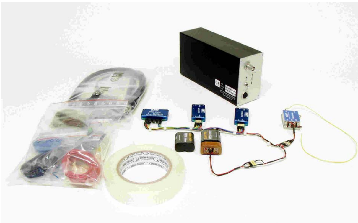
2-Kanal Funk-Telemetrie mit wählbaren Sensor-Signalverstärkern und einer Übertragungsrate von 40kbits
