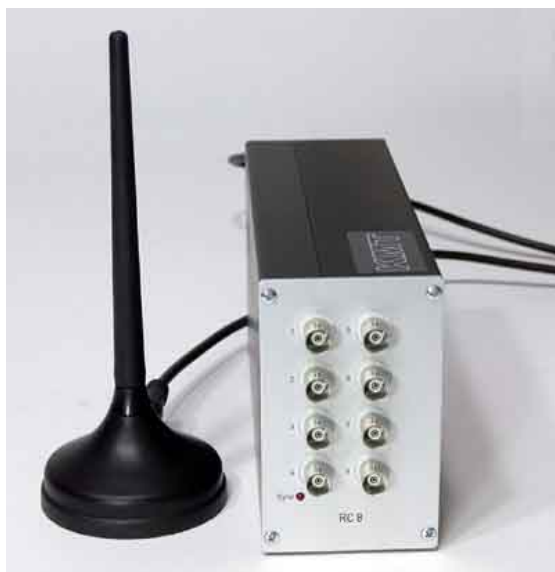
Bild 5.1: 8-Kanal Telemetrie-Encoder mit 8 analogen Ausgängen +/-5V
