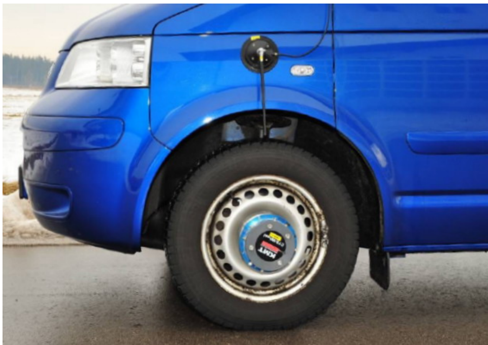
8-Kanäle: 4 x ICP_4mA, 2 x DMS und 2 x Thermo TH-K-ISO -50...1000C°
