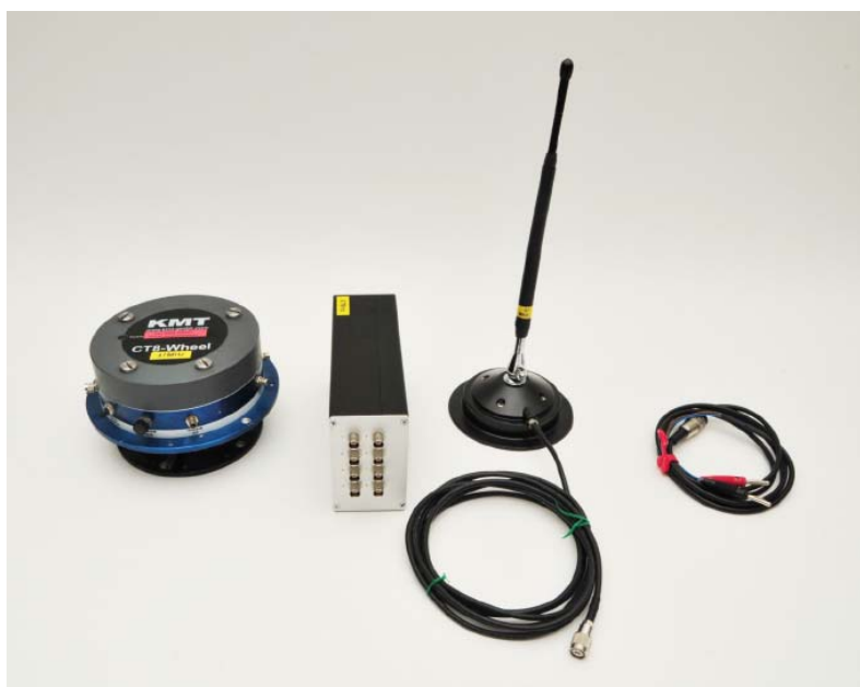
Lieferumfang: Rad-Telemetrie Sender, Empfänger mit 8 Ausgängen +/-5V und Empfangsantenne
