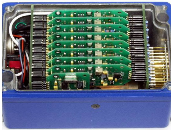
CT8-Sender geöffnet mit 8 austauschbaren Modulen (DMS, ICP, Thermo, Frequenz, Volt)
