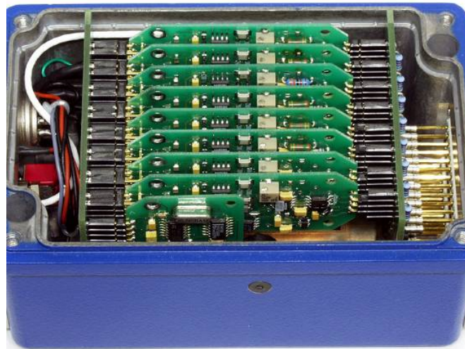
CT8-Sender geöffnet mit 8 austauschbaren Modulen (DMS, ICP, Thermo, Frequenz, Volt)
