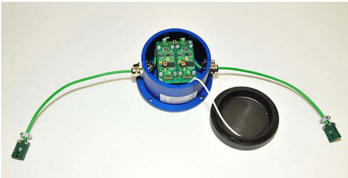
Beispiel: CT2-Wheel-ENC mit Thermoausgleichsleitung Type K
