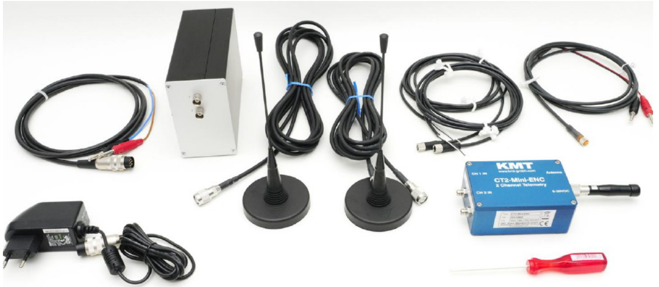
CT2-Mini-Diversity, Lieferumfang (SET) (der Decoder arbeitet mit zwei integrierten HF-Empfängern und mit zwei Empfangsantennen)
