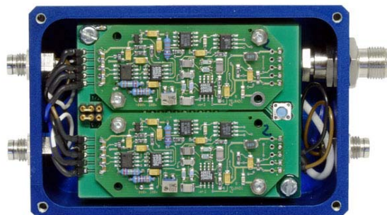
Sender geöffnet mit 2 austauschbaren Modulen (DMS, ICP, Thermo, Frequenz, Volt)
